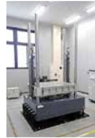
大型落下衝撃試験装置
